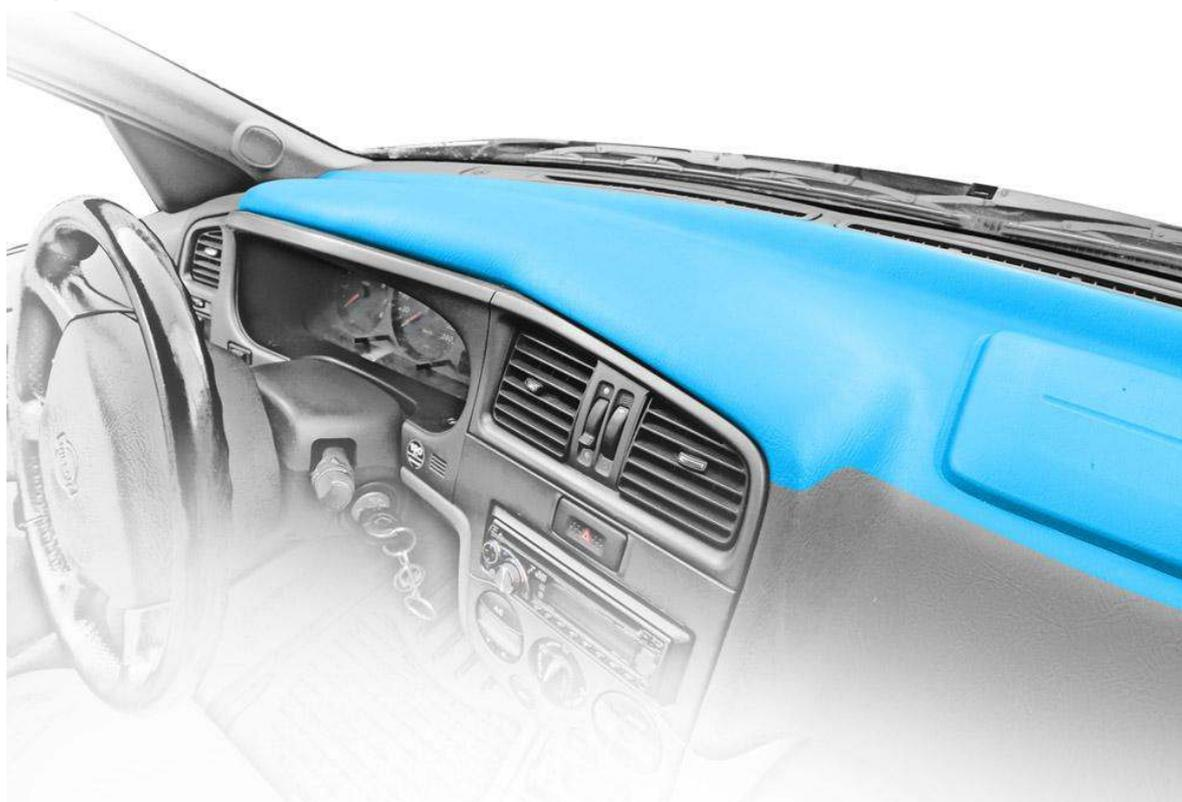
Рисунок 9. Зона предпочтительного размещения ГЛОНАСС/GPS-антенны
